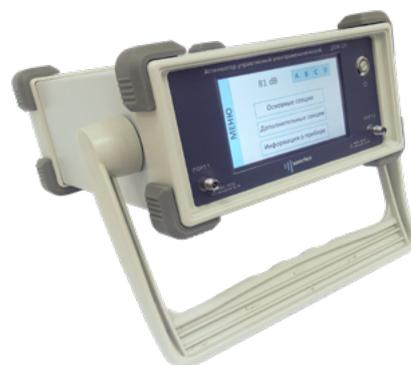
Аттенюаторы серии Д6М предназначены для ослабления мощности СВЧ-сигнала в диапазоне от 0 до 81 дБ с шагом 1 дБ. Диапазон рабочих частот от 0 до 26,5 ГГц.
